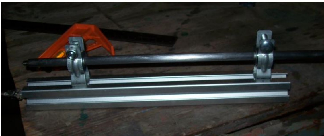
MONTAJE DEL EJE SOBRE EL PERFIL DE ALUMINIO, YA BARRENADO PARA FIJAR SOPORTES DE VALEROS.
