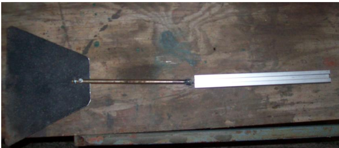
MONTAJE DE VELETA, QUE CONSTA DE UNA VARRILLA RECICLADA DE IMPRESORA, Y LA LAMINA DE UNA TAPA DE VIDEOCASSETERA.
