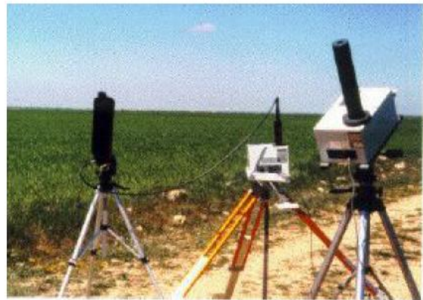
Figura Espectrorradiómetro Licor-1800. Rango de operación 300-1100. Apertura 4.7°. Universidad de Valencia, Grupo de Radiación Solar.
