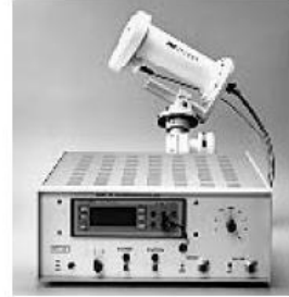
Figura Pirheliómetro autocalibrable de cavidad absoluta Modelo HF. Este modelo ha sido un estándar de referencia durante muchos años. CMDL (Climatic Monitoring and diagnostic Laboratory) Solar & thermal Atmospheric Radiation. NOAA. USA.
