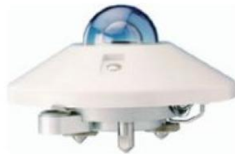
Figura Piranómetro CM 11. Está desarrollado para medida de la radiación solar global (rango espectral de 0.3 a 2.8 \mu\text{m} ), radiación difusa y radiación reflejada. Kipp & Zonen.
