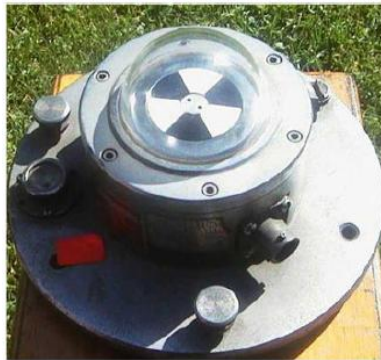
Figura Piranómetro negro y blanco de Eppley. Unas placas pintadas de blanco y de negro actúan como sensores.
