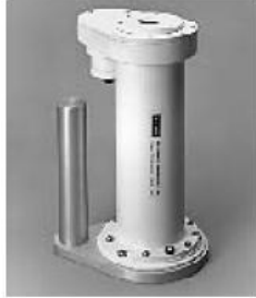
Figura Pirheliómetro autocalibrable de cavidad absoluta Modelo HF. Este modelo ha sido un estándar de referencia durante muchos años. CMDL (Climatic Monitoring and diagnostic Laboratory) Solar & thermal Atmospheric Radiation. NOAA. USA.
