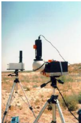
Figura Espectrorradiómetro Optronic754. Rango espectral 250-800. Aperturas: 0.5°, 1.0° y 1.5°. Universidad de Valencia, Grupo Radiación Solar.
