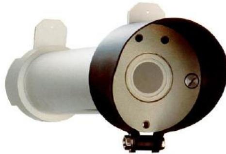
Figura Pirheliómetro autocalibrable de cavidad absoluta Modelo HF. Este modelo ha sido un estándar de referencia durante muchos años. CMDL (Climatic Monitoring and diagnostic Laboratory) Solar & thermal Atmospheric Radiation. NOAA. USA.
